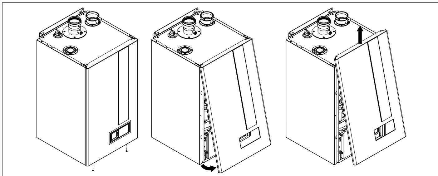
Fig. 42 Apertura revestimiento
