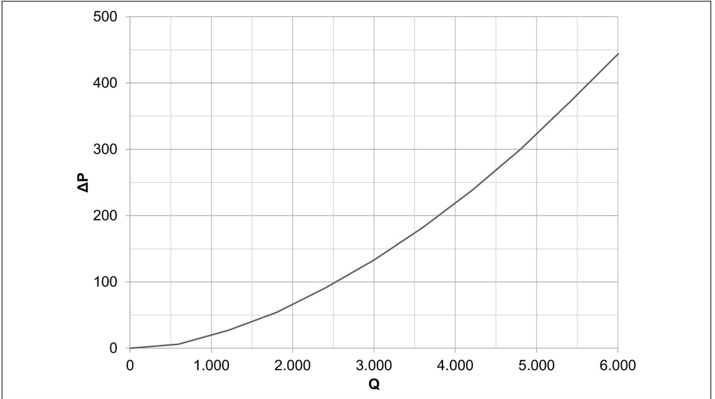
Fig. 26 Resistencia hidráulica B30 150
