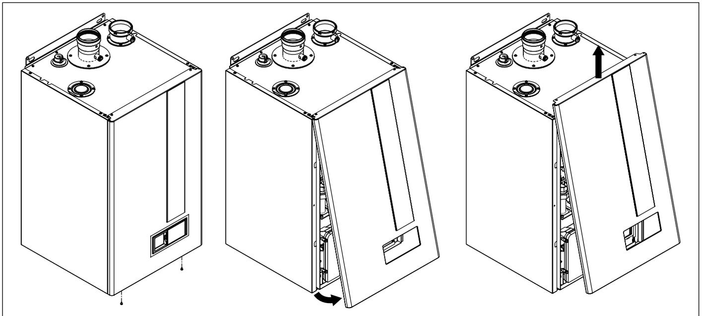
Fig. 37 Apertura revestimiento
