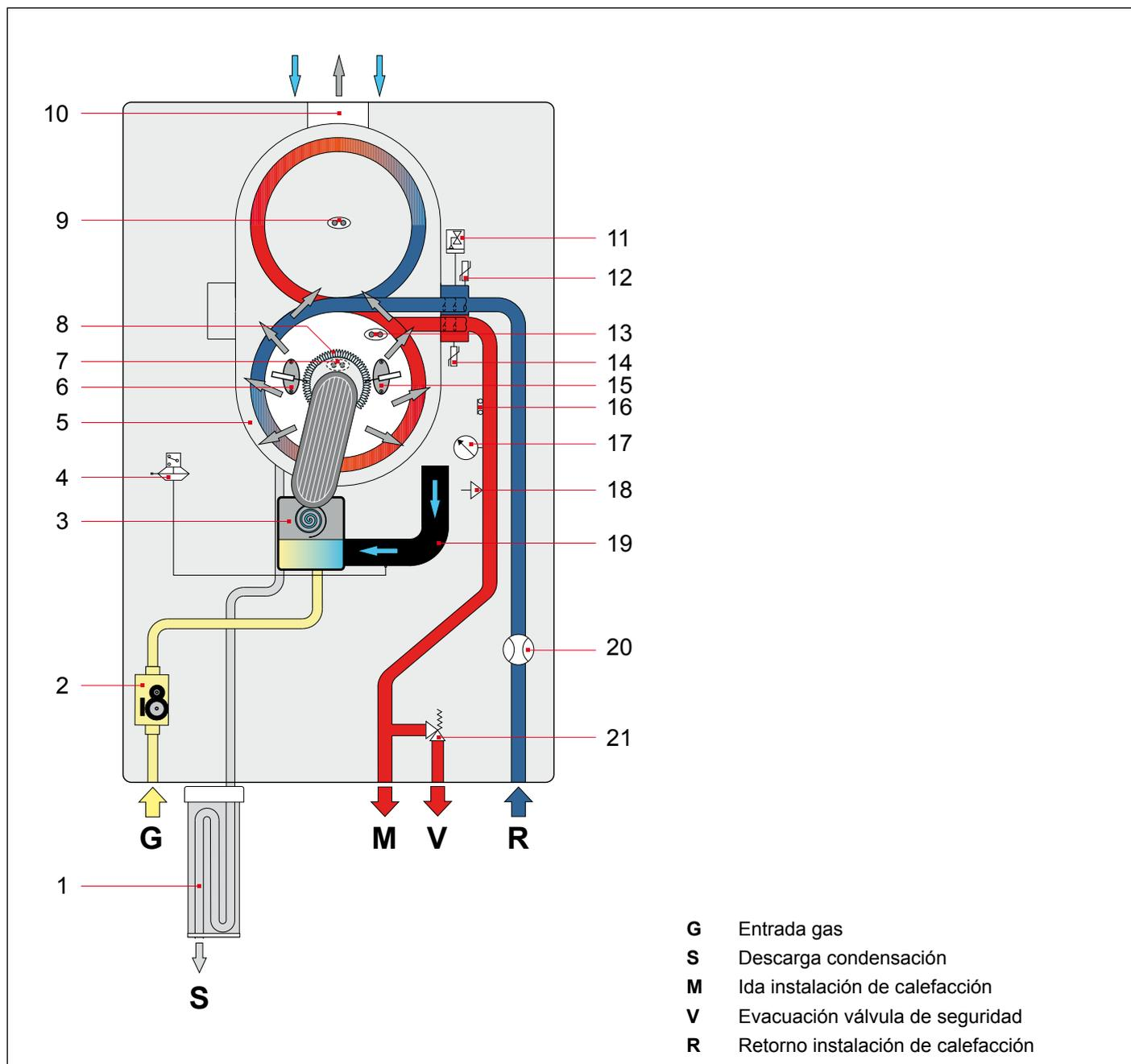
Fig. 11 Esquema hidráulico
