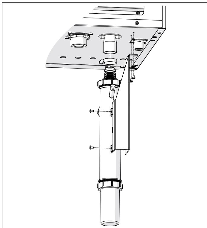
Fig. 13 Fijación del sifón
