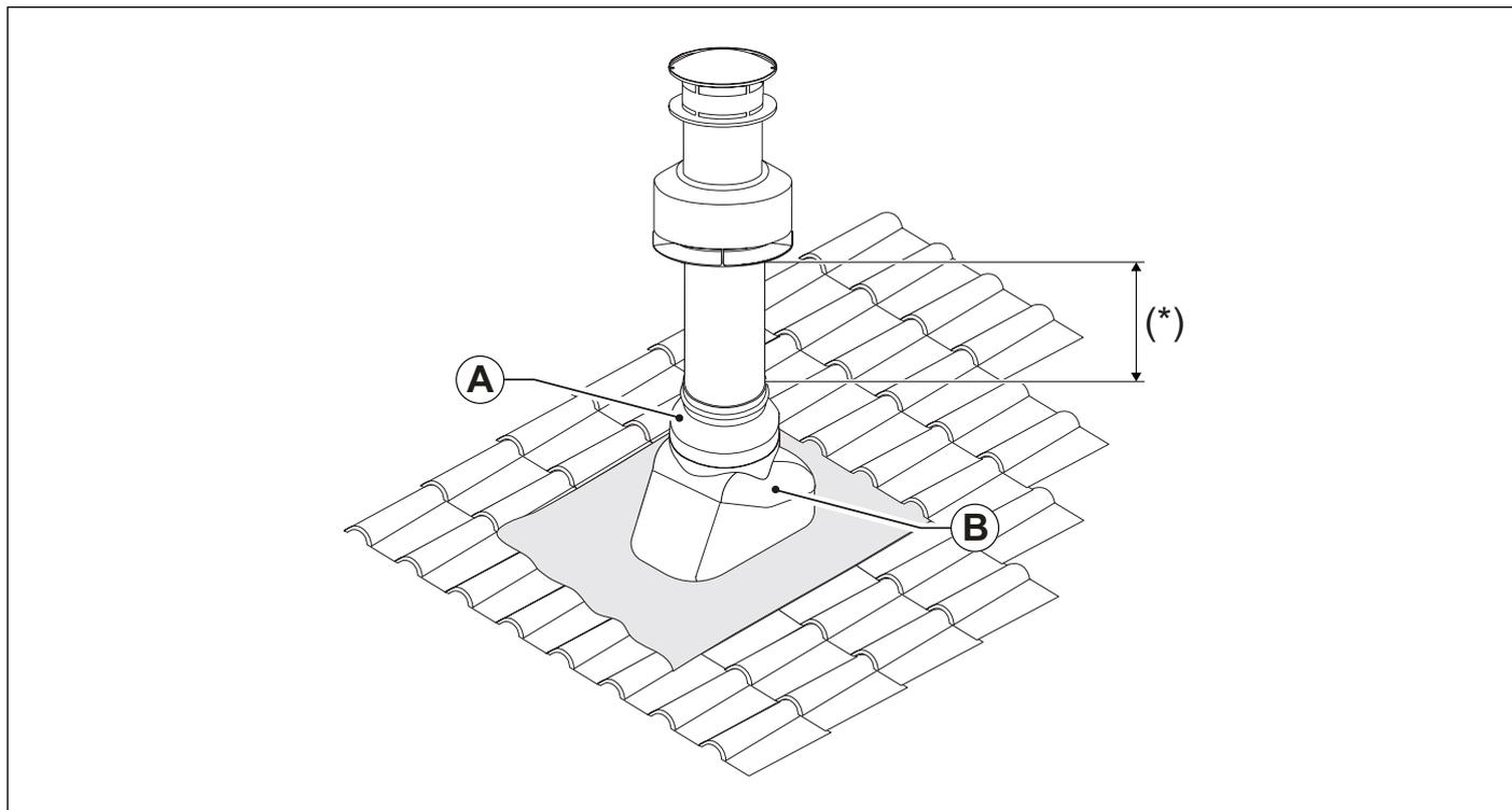
Fig. 20 Instalación chimenea en el tejado
